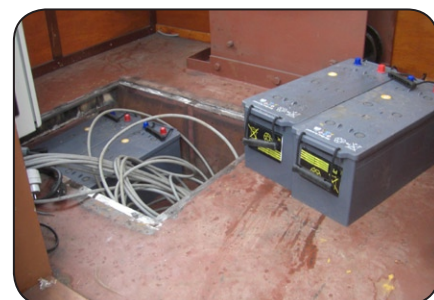
Plaatsen 240 Ah accubatterij
